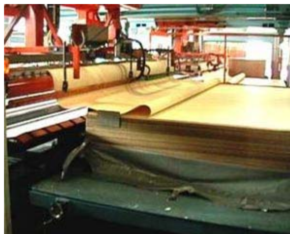
Рис. 6.42. Линия ламинирования с составляющими этой линии: а – линия быстрого ламинирования; б – подача плиты в пресс; в – мультивакуумное устройство с переворотной планкой для укладки пленки
