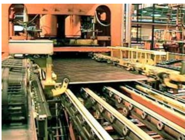
Рис. 6.42. Линия ламинирования с составляющими этой линии: а – линия быстрого ламинирования; б – подача плиты в пресс; в – мультивакуумное устройство с переворотной планкой для укладки пленки
