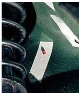
Рис. 23. Загрунтованные участки поверхности под удаленными технологическими наклейками остаются не покрытыми защитным составом
