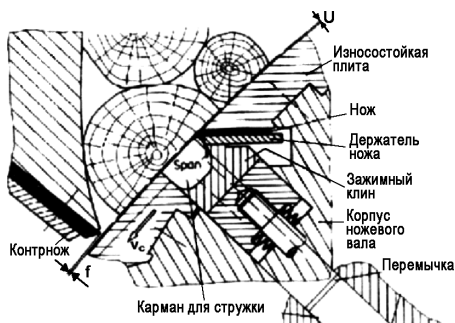
Рис. 4.6. Схема получения стружки на станке с ножевым валом: f – зазор между контрножом и корпусом, U – выступ ножа, V_c – скорость резания
