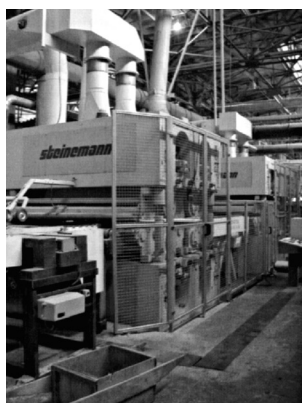
Линия шлифования в цехе ДСтП Сыктывкарского фанерного завода: слева - входная зона калибровального станка, справа - станок для тонкого шлифования, защищенный решётчатым ограждением
