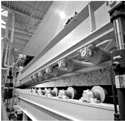
Специальный проходной пресс, используемый для холодной подпрессовки ковра из мелкодисперсной фракции, имеет удлиненную вентилируемую рабочую зону
