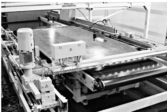
Прецизионная загрузочная каретка обеспечивает высокую точность позиционирования пакетов при подаче их на прессование
