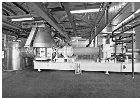
Напорный шнековый питатель Andritz 26 – крупнейшая в мире установка
