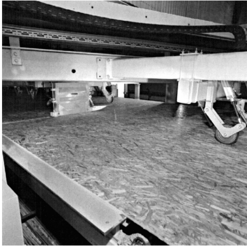
Готовая плита OSB шириной в 12 футов - около 4 метров
