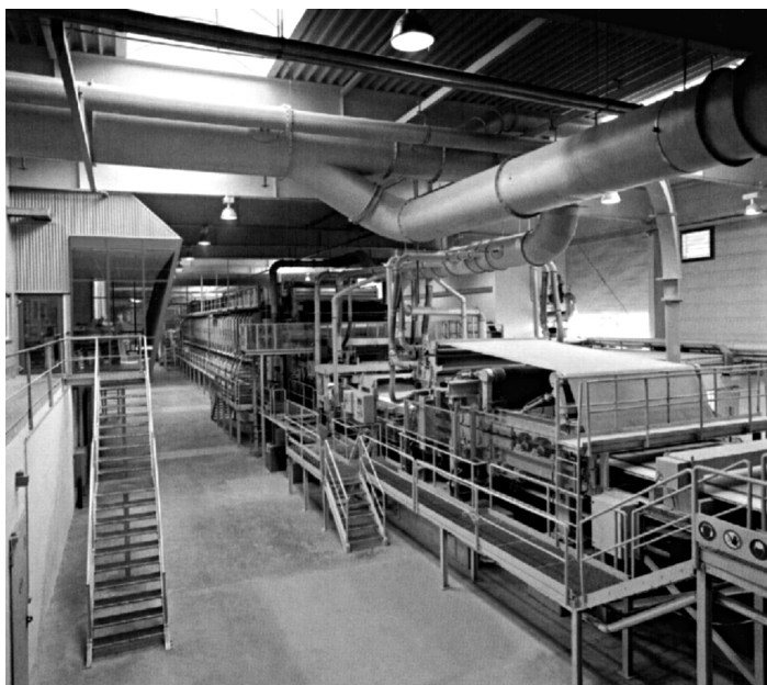
Проходной пресс для предварительной холодной подпрессовки стружечного ковра
