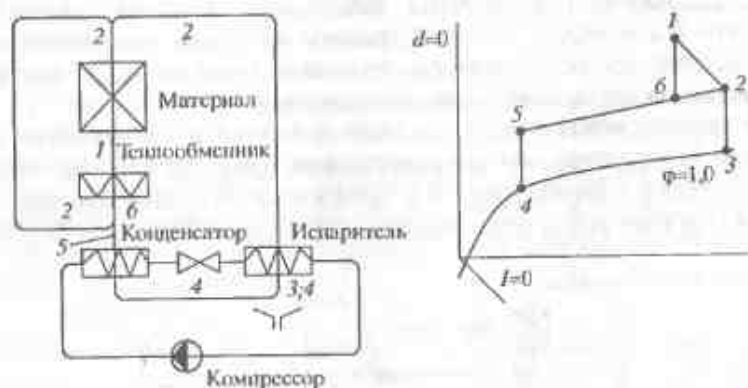
Рис. 6.3. Принципиальная схема и график процесса на Id -диаграмме конденсационной сушилки
